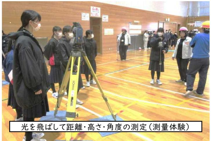
光を飛ばして距離・高さ・角度の測定(測量体験)
